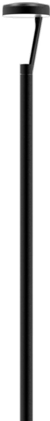
Palo cilindrico realizzato in acciaio S-235 JR galvanizzato a caldo da 4 a 8 m di altezza per fissaggio testa palo Ø60 o Ø100 per sbraccio ESSENTIALS. Finitura in nero opaco RAL 9005.
