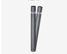
Dissuasore realizzato in composite con alta resistenza all'impatto. 100% riciclabile, con anello ornamentale in acciaio inossidabile nella parte superiore. Finitura opaca nero antracite. Ancoraggio raccomandato: mediante base di alloggiamento da ancorare in CLS, realizzata in acciaio zincato, munita di coperchio e di chiave.
