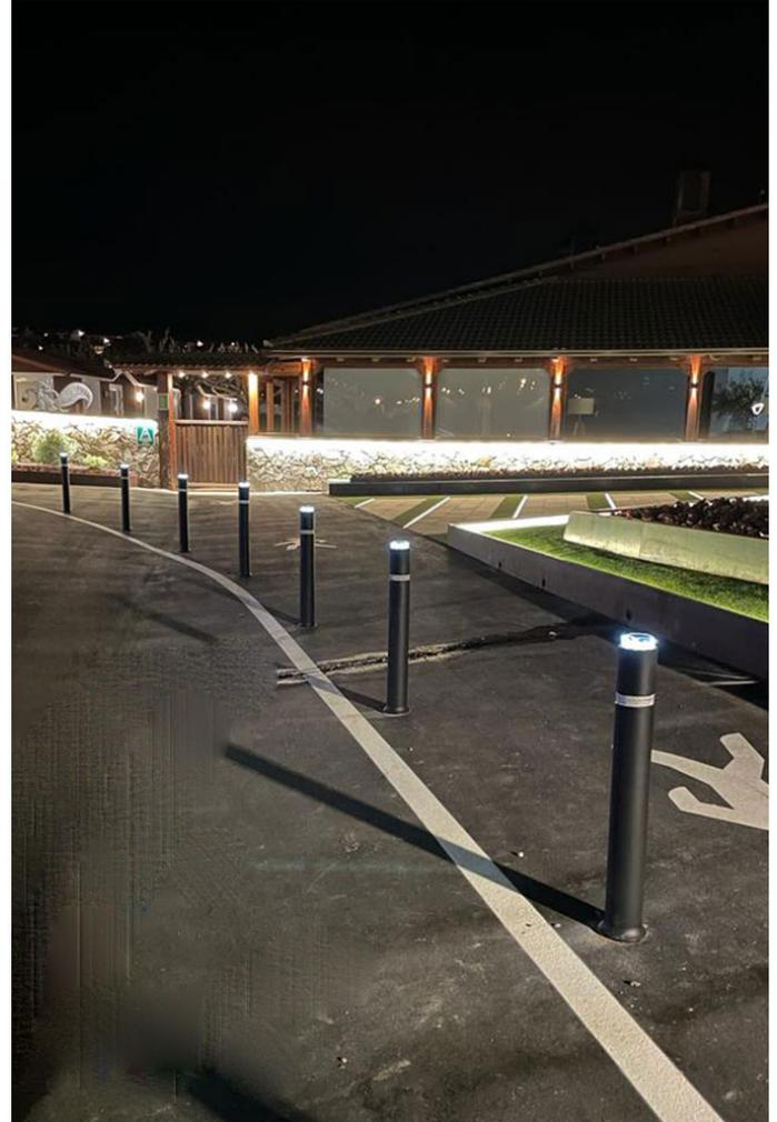
Flexible lumineuse solaire avec LED
