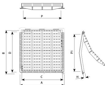
Concave est conçue pour supporter un trafic modéré. Idéale pour installation sur voies ayant un TMJ de 500 à 1.000, notamment sur accotements et caniveaux.
