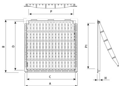
Plana est conçue pour supporter un trafic modéré. Idéale pour installation sur voies ayant un TMJ de 500 à 1.000, notamment sur accotements et caniveaux.
