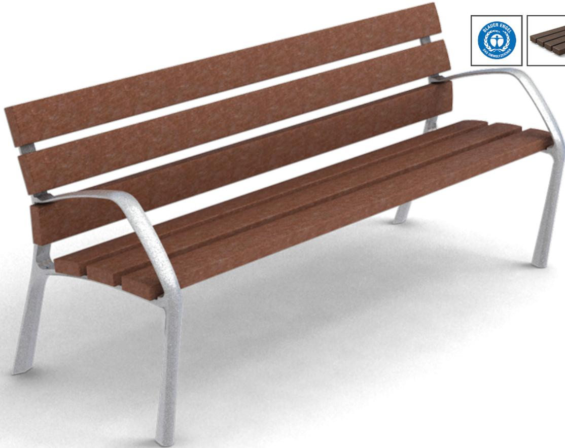
Pies de fundición dúctil con tratamiento Ferrus, proceso protector del hierro, que garantiza una óptima resistencia a la corrosión. Acabado imprimación epoxi y pintura poliéster en polvo color gris martelé. Perfiles REBNEW de sección 110x40x1800mm. Ecológico, proviene de producto reciclado y a la vez es reciclable. No requiere mantenimiento. No se astilla ni se agrieta, tampoco se pudre ni se reseca. Resistente a la humedad. Alta resistencia a las inclemencias. Resistente y duradero.
