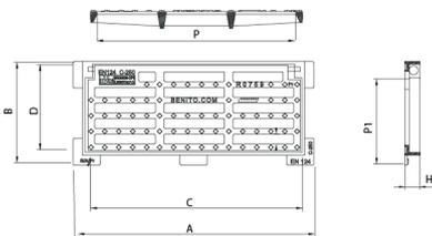
Abatible D4 está diseñada para soportar un tráfico medio. Perfecta para instalar en vías con una IMD de 1.000-20.000, especialmente calzadas de carreteras (incluyendo calles peatonales), arcenes estabilizados y zonas de aparcamiento para todo tipo de vehículos.
