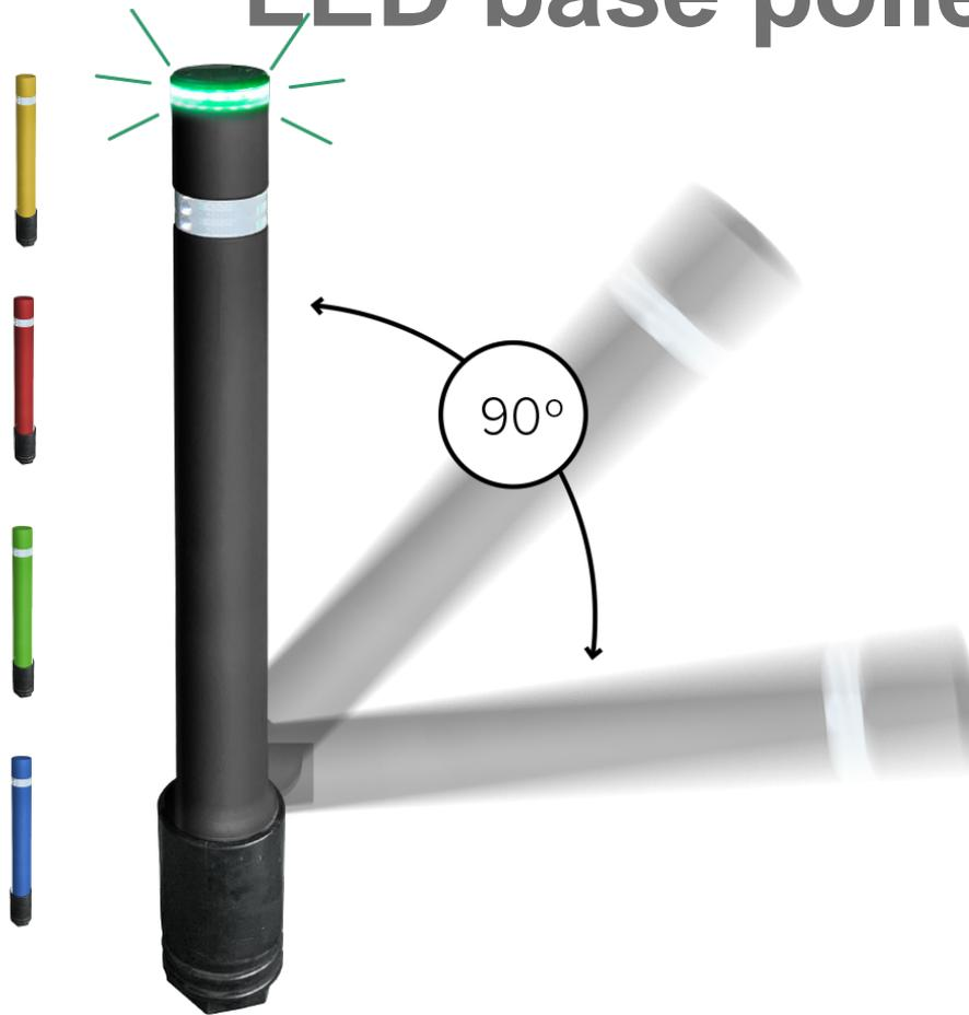
Pilona móvil luminosa con LED, fabricada en poliuretano flexible en color negro (opcional en rojo, verde, amarillo o azul), resistente a los rayos UV, con una banda reflectante. Base empotrable de polietileno negro.
