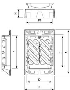
Tráfico D4, für intensiven Verkehr geeignet. Ideal für einen durchschnittlichen täglichen Verkehr von 1.000 bis 20.000, Fahrbahnen, Fußgängerzonen, Seitenstreifen, und Parkplätze für alle Fahrzeugarten.
