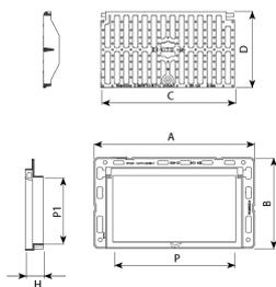
Duna C2 está diseñada para soportar un tráfico suave. Perfecta para instalar en vías con una IMD de 500 a 1.000, especialmente en arcones y cunetas.
