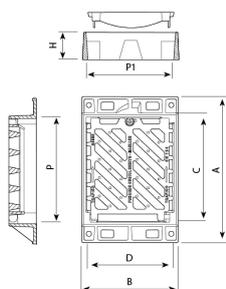
Tráfico D4 está diseñada para soportar un tráfico intenso. Perfecta para instalar en vías con una IMD de 1.000-20.000, especialmente calzadas de carreteras (incluyendo calles peatonales), arcenes estabilizados y zonas de aparcamiento para todo tipo de vehículos.
