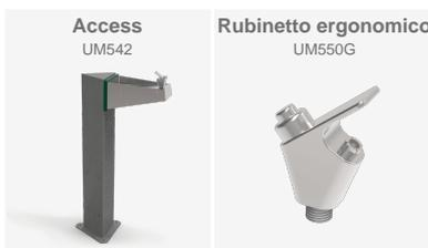
Fontana realizzata con una colonna di acciaio con trattamento Ferrus, un processo protettivo che garantisce un'ottima resistenza alla corrosione. Il trattamento consiste in una granigliatura per eliminare tutti i tipi di sporcizia ed ossidazioni, un bagno elettrolitico, seguito da una mano di primer epossidico ed una mano finale di vernice a polvere di poliestere in colore grigio antracite.
