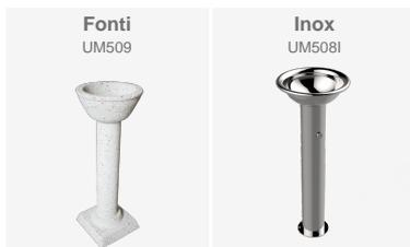
Fontana realizzata in ghisa sferoidale con trattamento Ferrus, un processo protettivo che garantisce un'ottima resistenza alla corrosione. Il trattamento consiste in una granigliatura per eliminare tutti i tipi di sporcizia ed ossidazioni, un bagno elettrolitico, seguito da una mano di primer epossidico ed una mano finale di vernice a polvere di poliestere in colore antracite.
