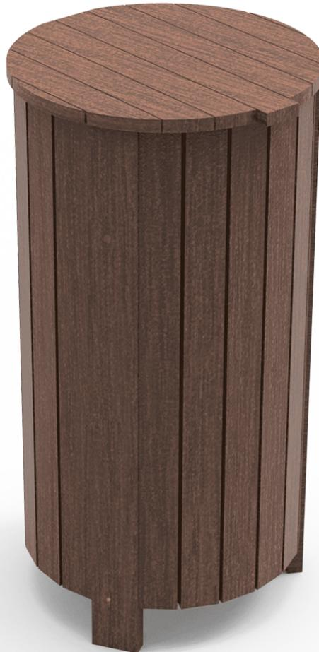
Portarifiuti realizzato in plastica riciclata Rebnew, con coperchio incernierato e reggi sacco all'interno. Viteria in acciaio inossidabile. Ancoraggio raccomandato: mediante tasselli ad espansione M10 in base alla superficie del progetto.
