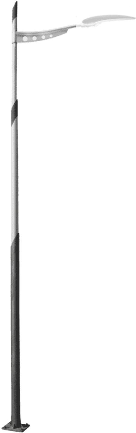
Palo realizzato in acciaio S-235-JR galvanizzato. Verniciato in due colori, la base in grigio antracite ed il palo in grigio RAL 9006. Spessore (base, palo): 4,5 mm, 3 mm [ICBAM40: 3 mm, 3 mm].
