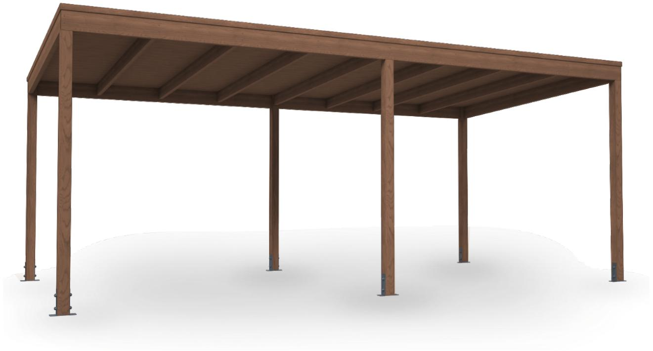
Pergola autoportante double pente de 6000 x 3000 mm en bois de pin d'Oregon européen (Douglas) : poteaux de 90 x 90, poutres de 170 x 45, poutrelles de 140 x 45 et plaque emboîtée de 115 x 21. Finition lasure, 100 % naturelle à base d'huiles et de résines végétales, avec protection anti-UV.
