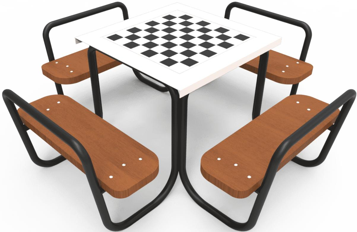
Spieltisch aus Kiefernholzleisten, entgegen der Maserung geschnitten. Spielfläche mit Phenolschicht. Rohrstruktur aus Stahl in 40mm Stärke mit Ferrus-Behandlung zum optimalen Korrosionsschutz
