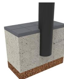
Die Ferrus-Behandlung besteht aus drei Schritten, in denen das Metall nach entfernen der Unreinheiten durch Kugelstrahlen, zunächst feuerverzinkt wird. Danach wird ein Epoxyd-Primer aufgetragen und schließlich ein Polyester-Pulverbeschichtung in RAL 7016. Empfohlene Verankerung: Einbetonieren
