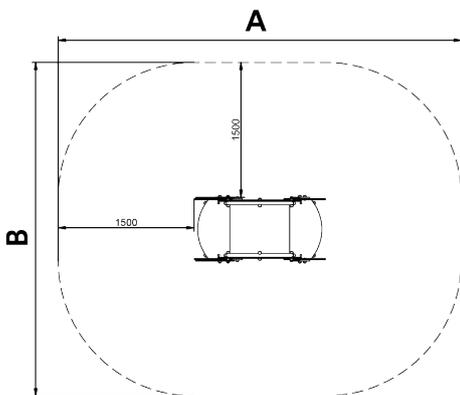
Struktur, Metall: Pfosten mit Durchmesser 35mm aus AISI304 Edelstahl, extrem korrosions- und witterungsbeständig. Die Rutsche besteht aus poliertem AISI304 Edelstahl in 2 mm Stärke, aus einem Teil gewellt und geformt.
